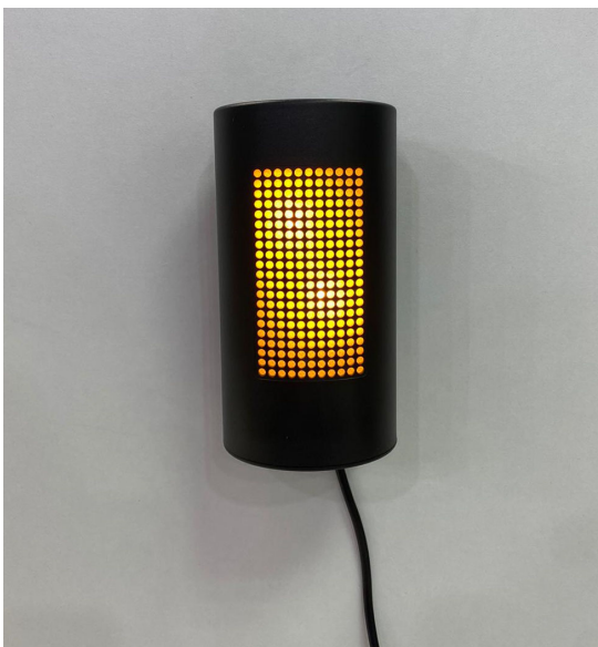
Bild 5: Beispiel einer CO 2 Stoplicht, die durch Wandhalterung an der Wand befestigt ist.
